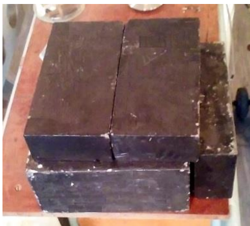
Rys. 3. Rozsuwana komora ołowiana z umieszczonym wewnątrz emiterem promieniowania \beta^+ Źródło: opracowanie własne.
