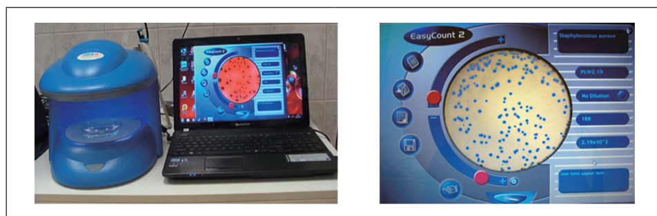
Fot. 2. Automacyjny licznik kolonii z oprogramowaniem komputerowym Easy Count 2 model 7510/AES AES CHEMUNEX
